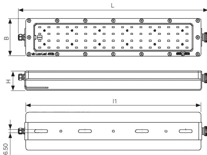
Exécution standard avec câble 2 m, verre flotté (clair), étrier de fixation, alimentation directe 24 VDC.
