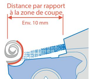
Comparaison de l'écoulement du liquide d'arrosage
